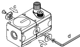
**Koppelklammern montieren (BG1 ... BG5)**
