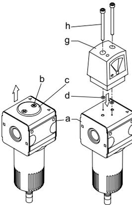
**Installer le manomètre différentiel**
